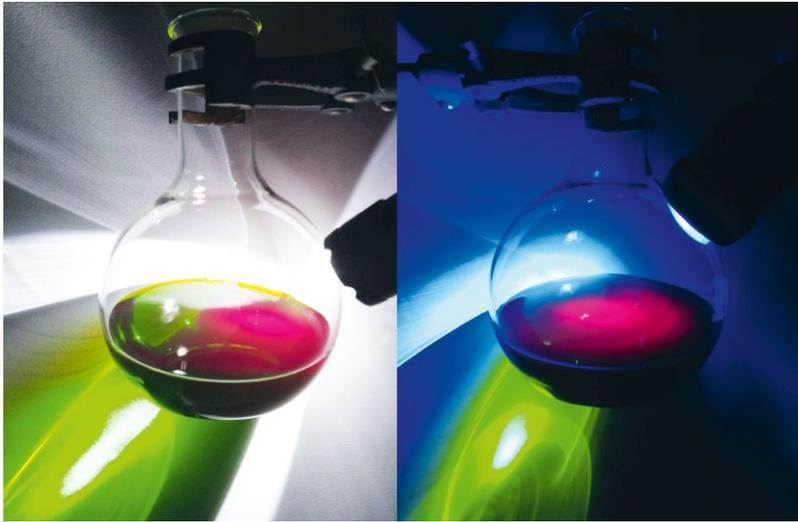
**ABB. 2** Chlorophylllösung im Rundkolben mit weißem Licht (links) und mit blauem Licht (rechts) bestrahlt. Die Lösung fluoresziert intensiv rot. Fotos: A. Korn-Müller.
