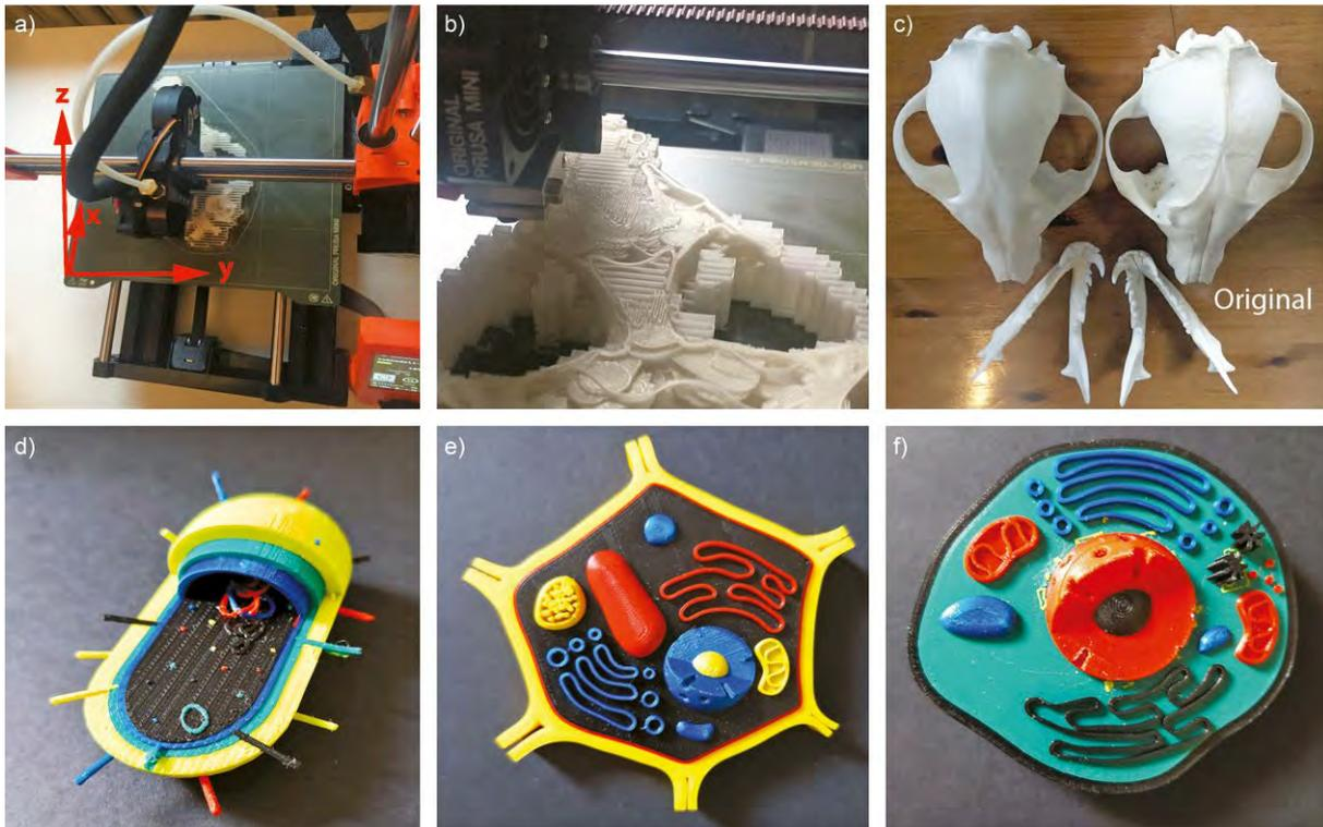
**ABB. 1** Biologische Modelle durch 3D-Druck. a) Aufsicht auf die in x-Richtung bewegliche Druckplatte und den in y-, z-Richtung beweglichen Druckkopf. b) Schichtweises Drucken des Modells eines Schädels mit dem entsprechenden Stützmaterial. c) Schädelmodell und Original. Einfaches, farbig gedrucktes Modell eines Bakteriums (d), einer Pflanzenzelle (e) und einer tierischen Zellform (f). Fotos: H. Böhm.
