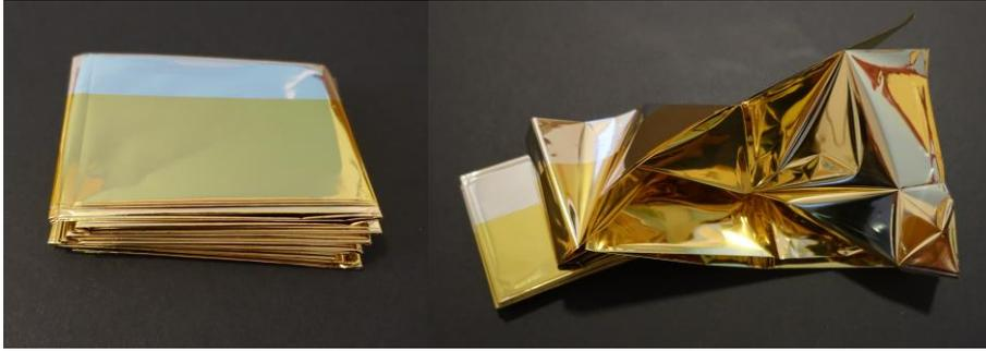
**ABB. 2** Eine Packung hauchdünner Rettungsfolie nach dem Auspacken (links) und nach dem Auffalten (rechts). Die Vorderseite ist golden, die Rückseite ist silbern beschichtet. Foto: Andreas Korn-Müller.
